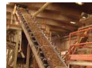
2) Zerkleinerung des reinen Holzes in faserige Strukturen; Abtrennen von Störstoffen;
