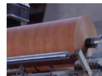
4) Beschichtung mit imprägniertem und beschichtetem Papier zu Laminatplatten;
