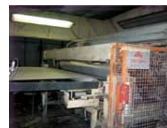
4) Beschichtung mit imprägniertem und beschichtetem Papier zu Laminatplatten;
