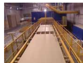
3) Vermischung mit Harz und Verpressung zu Rohplatten;
